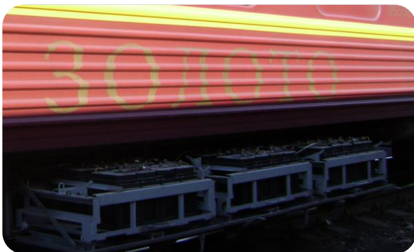
Опытные АКБ типа 52 PzV 350 на пассажирских вагонах туристического поезда «Царское золото»
